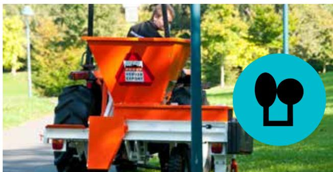
**City Planter :** plante les bulbes à fleurs sur une largeur de 50 cm. Le soc de plantation de cette machine se trouve sur le flanc de la machine. Elle convient pour les endroits où vous souhaitez planter d'arbre en arbre, de poteau en poteau, de banc en banc.
