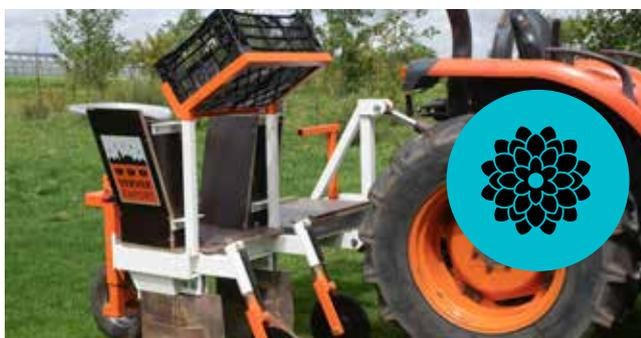
**Dahlia Planter :** une City Planter double où les tubercules sont jetés manuellement dans la trémie et plantés en deux rangs. Il n'y a pas de rouleau compresseur ou autre engin d'égalisation accroché derrière la machine étant donné que le sol doit rester meuble. Ne peut pas être utilisé sous le gazon car le sol doit tout d'abord être fraisé.
