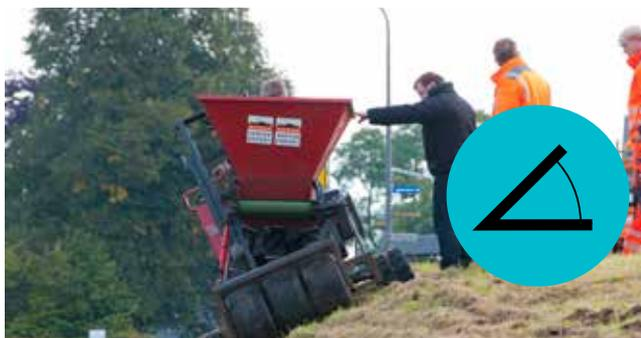
**Talus Planter :** cette machine peut planter sur une pente avec un angle maximum de 30 à 35 degrés. Elle est équipée de chenilles et d'un soc de plantation supplémentaire pour un aspect uniforme.
